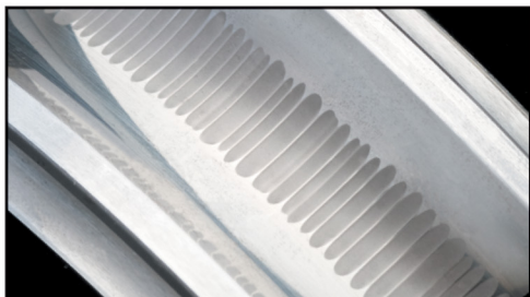
Wellenströme können Riffelungen in der Lagerlaufbahn verursachen, was zu einem vorzeitigen Lagerausfall führt.
