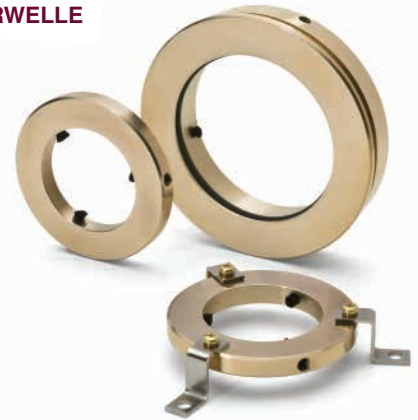
Der Inpro/Seal® CDR® verwendet firmeneigene leitfähige Bürsten, um schädliche Blindströme an der Welle von den Lagern abzuleiten.
