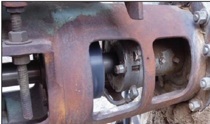
Einer der zwei Air Mizer aus Edelstahl in geteilter Ausführung, die auf Weißlaugentank-Rührwerken installiert wurden.
