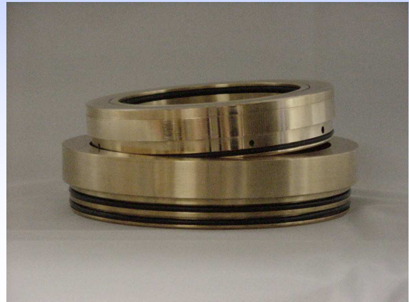
Bild 2: Falsche Montage, führt zum Ausfall der Dichtung
