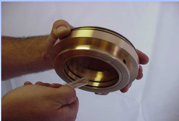
O- Ringe mit Schmierfett benetzen
